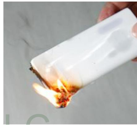
Используется для испытаний огнезащитных свойств изолированных корпусов бытовых приборов, панелей переключателей, печатных плат и изоляционных материалов.
