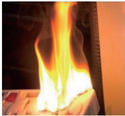
Используется для испытаний опасности воспламенения электронных и электротехнических изделий, оценки характеристик теплового горения и проведения испытаний на стойкость к воздействию высоких температур.
