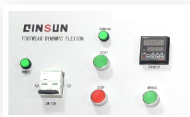
Кнопочная панель + модуль таймера и счётчика
