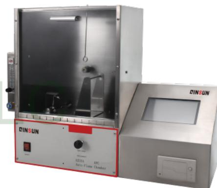
Испытатель воспламеняемости под углом 45° широко используется для испытаний огнезащитных свойств тканей в текстильных изделиях, игрушках и мягкой мебели с целью обеспечения правильного и безопасного использования текстильных материалов и предотвращения угрозы жизни, связанной с их воспламеняемостью.
