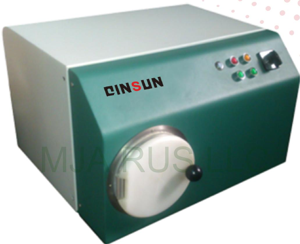
Прибор для испытания усадки при пропаривании
